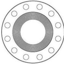
La norma ASME B16.5 exige que la superficie de sellado (RF y FF) tenga una rugosidad específica para asegurarse que las superficies de sellado (RF y FF) sean compatibles con el material de la empaquetadura y generen así un sello de alta calidad.
