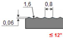
El acabado más usado porque prácticamente es universal: sirve para todas las condiciones de trabajo usuales. Cuando se comprime, los cerros se incrustan en la cara blanda de la empaquetadura, generando así un sello y generando un alto nivel de fricción entre las dos superficies de contacto.
